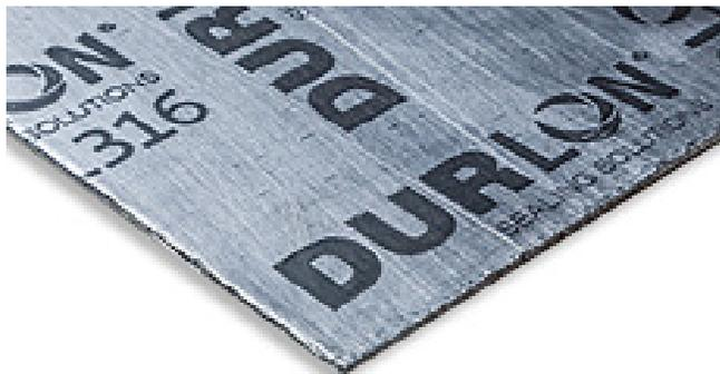
**FGL316:** Lámina de grado industrial estándar laminada con una unión adhesiva en ambos lados de un núcleo de hoja de acero inoxidable 316 de espesor 0.002". Ideal para aplicaciones donde se requiere alto rendimiento y facilidad de manipulación.
