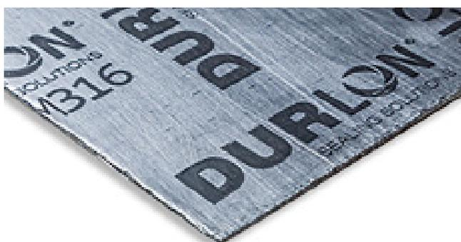
**FGM316:** Lámina con inhibidor fabricada con múltiples capas de núcleo de hojas de acero inoxidable 316 de espesor 0,004". Ideal para aplicaciones con alta tensión mecánica o presión, con una resistencia al estallido superior a la media, rigidez excepcional y apta para cortar juntas con tramos estrechos.
