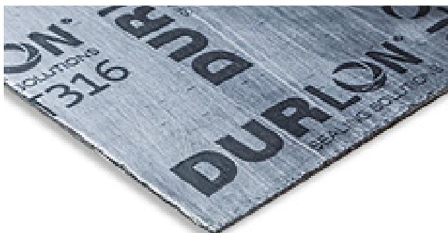
**FGT316:** Lámina estándar de grado industrial unida mecánicamente en ambos lados de un núcleo de espiga de acero inoxidable 316 de espesor 0,004". Ideal para aplicaciones con altas tensiones y presiones, y donde la manipulación es muy importante.
