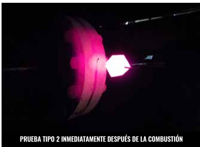
Figura 2 (se refiere a las 3 imágenes anteriores): Montaje de la prueba API 6FB Tipo 2 (offshore) antes de la combustión (arriba a la izquierda), prueba durante la combustión (arriba a la derecha) y prueba inmediatamente después de la combustión (abajo a la izquierda).
